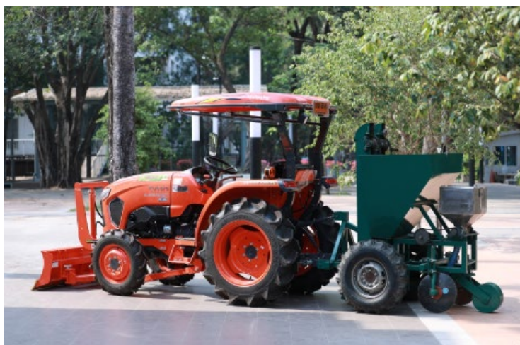
ภาพที่ 4.3.3 เครื่องปลูกอ้อยแบบซอตาอ้อยไม่เพาะกล้า มหาวิทยาลัยเกษตรศาสตร์ (แหล่งที่มา : ปิยะพงษ์และคณะ)
