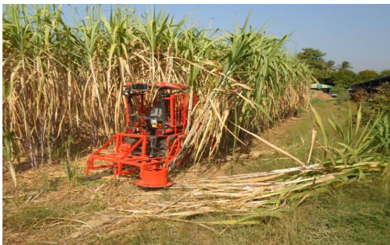
ภาพที่ 4.5.3 เครื่องตัดพันธุ์อ้อย (แหล่งที่มา : บริษัทสยามอินพลีเมนต์)
