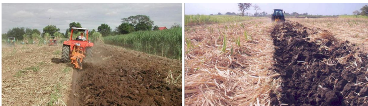
ภาพที่ 5.1.8 การใช้เครื่องสับใบและกลบเศษซากอ้อยเตรียมดินหลังตัดอ้อยสด (แหล่งที่มา : ศูนย์วิจัยพืชไร่สุพรรณบุรี)
