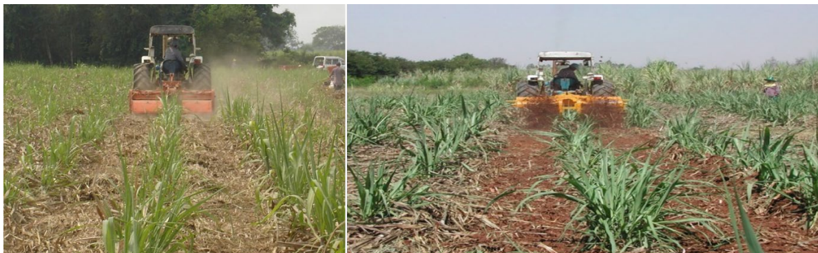
ภาพที่ 5.1.5 การจัดการใบและเศษซากอ้อยโดยใช้เครื่องสับใบระหว่างแถวอ้อยต่อ (แหล่งที่มา : ศูนย์วิจัยพืชไร่สุพรรณบุรี)
