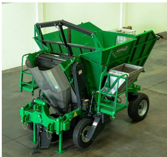
ภาพที่ 4.3.2 เครื่องปลูกอ้อยแบบท่อน (แหล่งที่มา : บริษัท Gessner Thailand)
