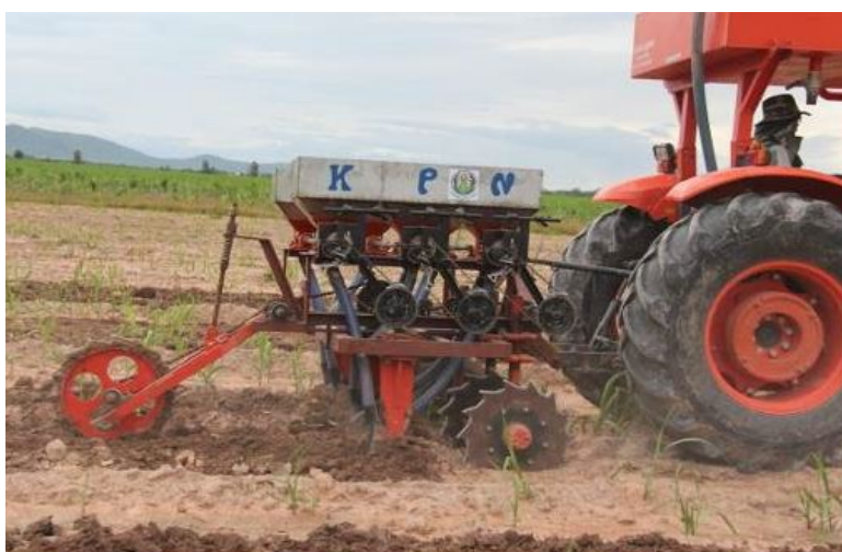
ภาพที่ 4.4.2 เครื่องหยอดปุ๋ยแบบผสมแม่ปุ๋ยภายในตัวเองสำหรับอ้อย
