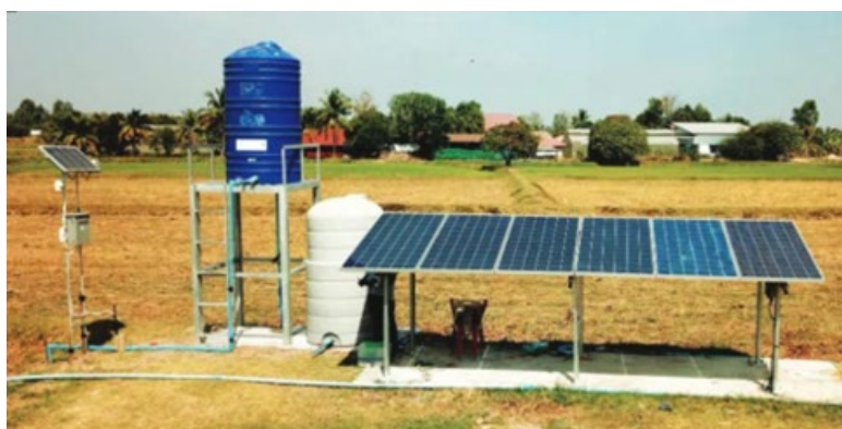
ภาพที่ 4.4.3 ระบบให้น้ำแปลงอ้อยแบบอัจฉริยะ DOA-SIS (แหล่งที่มา : ชยันต์และคณะ ศูนย์วิจัยพืชไร่ขอนแก่น)
