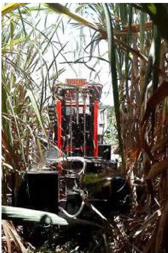
ภาพที่ 4.2.1 เครื่องสางใบอ้อยสำหรับอ้อยตัดทำพันธุ์โดยใช้ระบบไฮดรอลิก กรมวิชาการเกษตร (แหล่งที่มา : ตฤณสิษฐ์และคณะ สถาบันวิจัยเกษตรวิศวกรรม)
