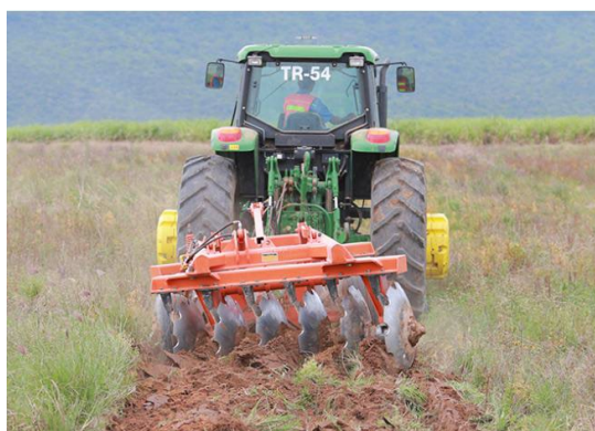
ภาพที่ 4.1.2 ชุดจานพรวน 2 ชุด รวมทั้งหมด 12 ใบ (แหล่งที่มา : บริษัทมิตรผลโมเดิร์นฟาร์ม)
