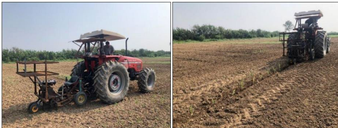
ภาพที่ 4.3.4 เครื่องปลูกกล้าอ้อย กรมวิชาการเกษตร (แหล่งที่มา : สุภากรและคณะ)
