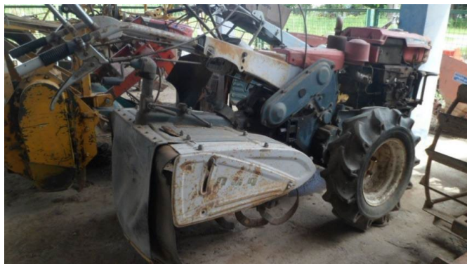
ภาพที่ 3.8.5 เครื่องพรวนดินและกำจัดวัชพืชระหว่างร่องอ้อยพ่วงรถไถเดินตาม (แหล่งที่มา : ชุศักดิ์ คุณุไทย)
