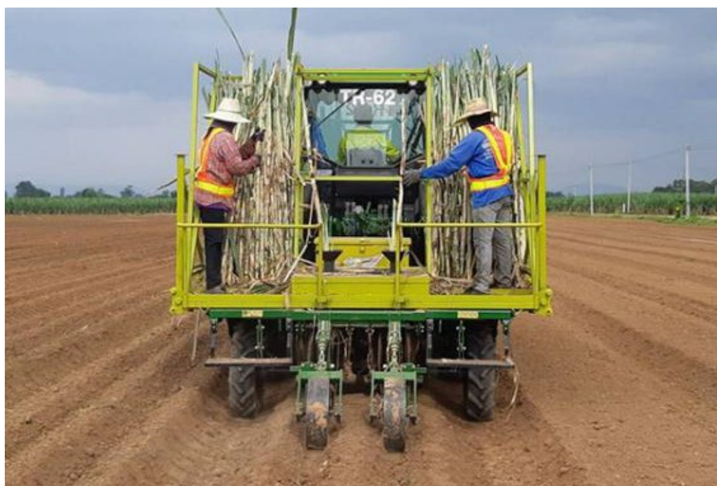
ภาพที่ 4.3.1 เครื่องปลูกอ้อยแบบป้อนเป็นลำแบบจานคู่ (แหล่งที่มา : บริษัทมิตรผลโมเดิร์นฟาร์ม)
