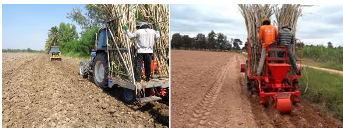
ภาพที่ 3.3.2 การปลูกด้วยเครื่องปลูก แบบแถวเดี่ยวหรือแถวคู่ (แหล่งที่มา : รวีวรรณ เชื้อกิตติศักดิ์)
