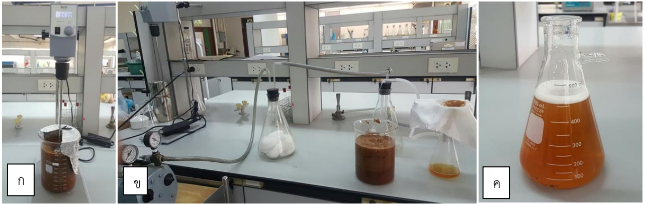
ภาพผนวกที่ 4 การระเหยเอทานอลในสารสกัดที่ระดับอุณหภูมิ 60 องศาเซลเซียส (ก) และ สารสกัดจากเปลือกมะพร้าวภายหลังการระเหยเอทานอลเป็นระยะเวลา 6 ชั่วโมง เพื่อนำไปวิเคราะห์สารแทนนินต่อไป (ข)
