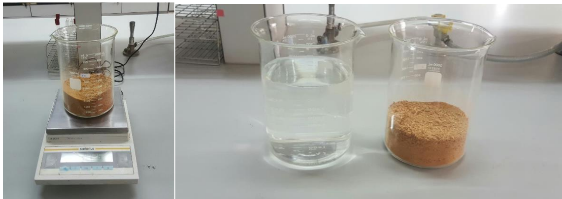
ภาพผนวกที่ 2 การเตรียมตัวอย่างเปลือกมะพร้าว(ส่วนในและนอก) แห้งปั่นละเอียด ในอัตราส่วนระหว่าง สารละลายเอทานอลความเข้มข้นในระดับต่าง ๆ ต่อ ตัวอย่างเปลือกมะพร้าวแห้งปั่นละเอียด (1:6)
