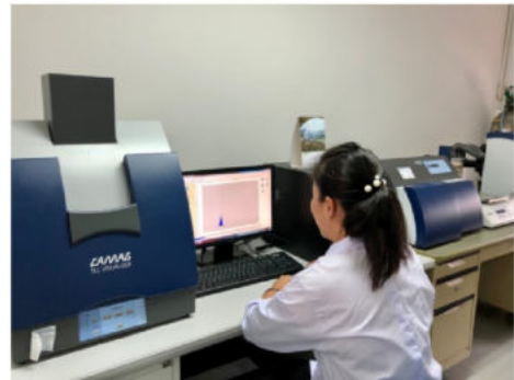
ภาพที่ 3 การตรวจวิเคราะห์หาปริมาณซาโปนินในสารสกัดจากขาน้ำมันด้วยเทคนิคโครมาโทกราฟีแบบแผ่นบางสมรรถนะสูง (High Performance Thin-layer Chromatography (HPTLC)
