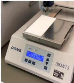
ภาพที่ 3 การตรวจวิเคราะห์หาปริมาณซาโปนินในสารสกัดจากขาน้ำมันด้วยเทคนิคโครมาโทกราฟีแบบแผ่นบางสมรรถนะสูง (High Performance Thin-layer Chromatography (HPTLC)
