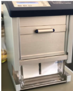
ภาพที่ 3 การตรวจวิเคราะห์หาปริมาณซาโปนินในสารสกัดจากขาน้ำมันด้วยเทคนิคโครมาโทกราฟีแบบแผ่นบางสมรรถนะสูง (High Performance Thin-layer Chromatography (HPTLC)
