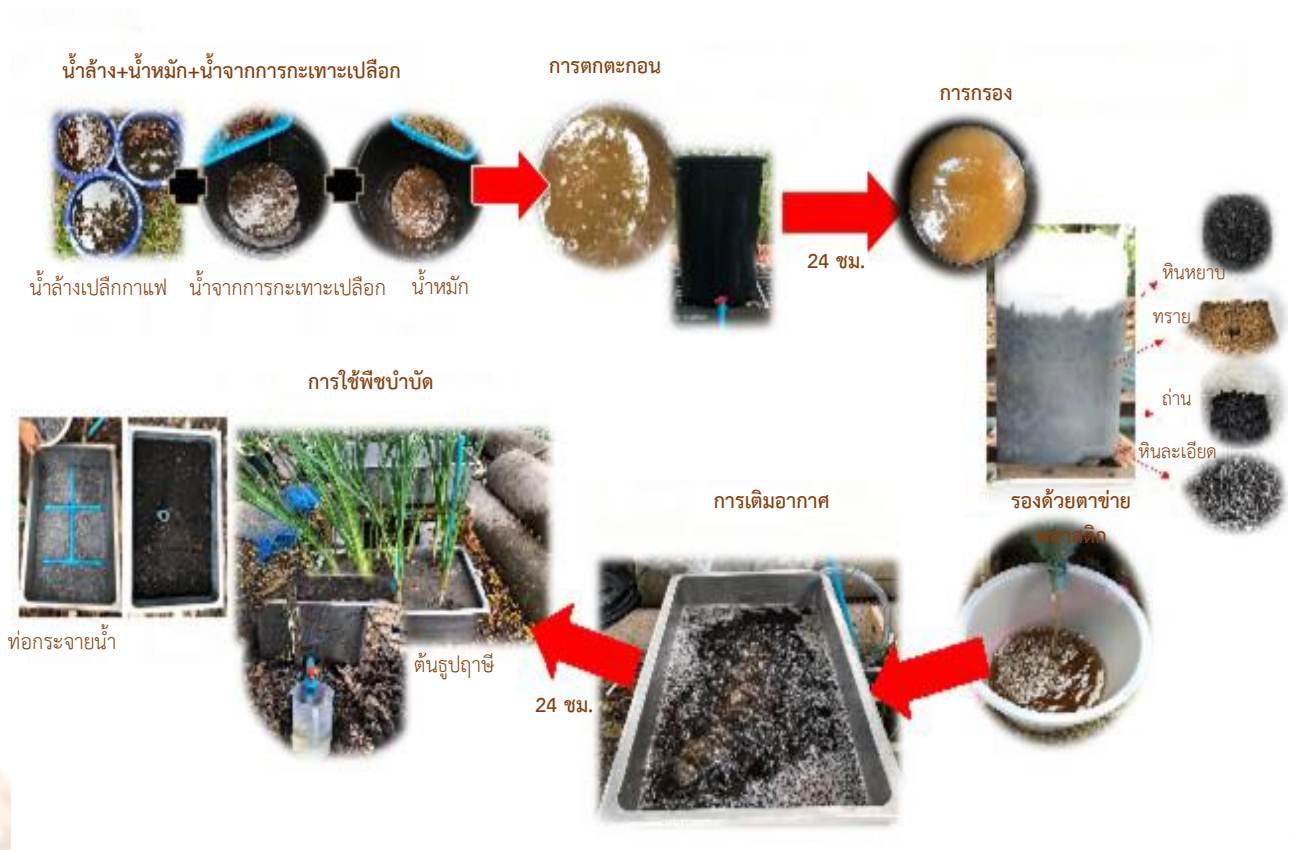
การบำบัดน้ำเสียจากการหมักกาแฟโดยกระบวนการบ่อบำบัด
