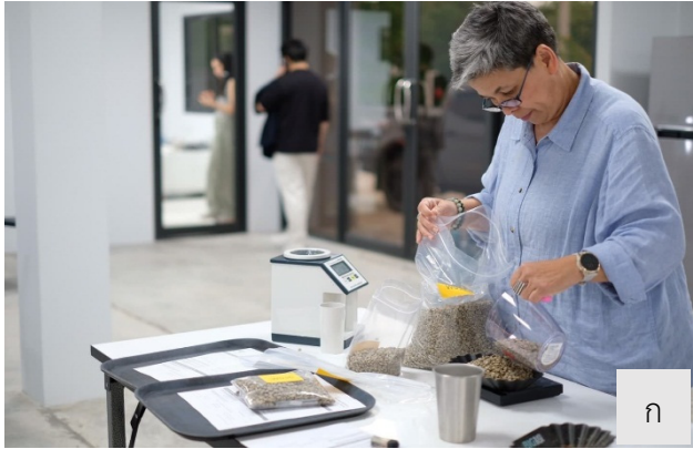
ภาพที่ ๔ การวัดความหนาแน่นเมล็ดกาแฟก่อนคั่ว (ก) การเตรียมเครื่องคั่ว (ข)
