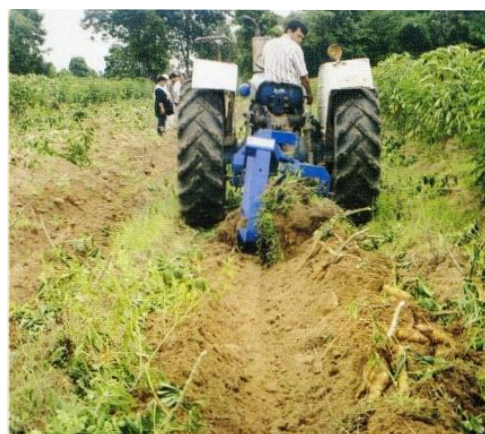
ภาพที่ 28 เครื่องขุดมันสำปะหลังแบบไถหัวหมู
