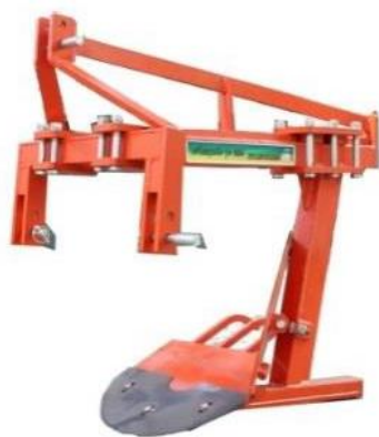
ภาพที่ 28 เครื่องขุดมันสำปะหลังแบบไถหัวหมู
