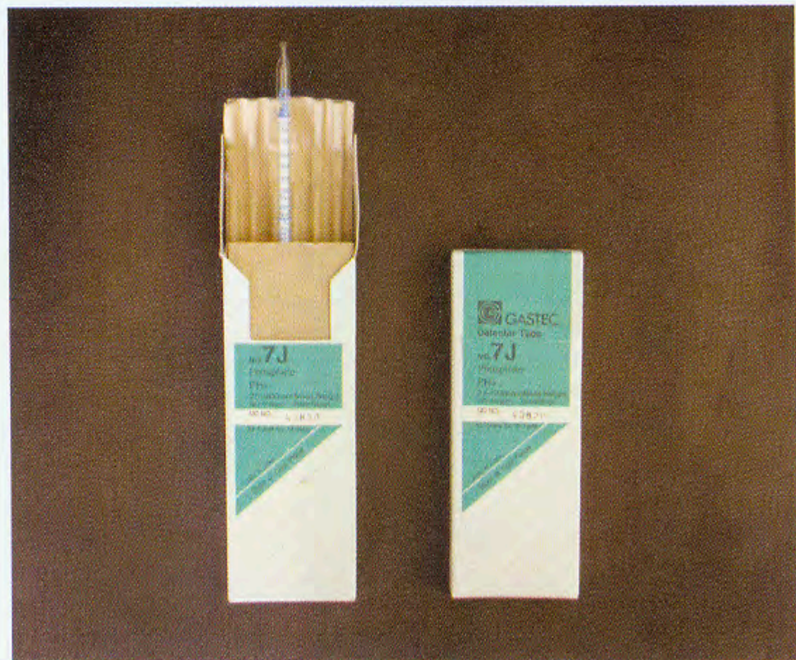
หลอดวัดแก๊สฟอสฟีน
