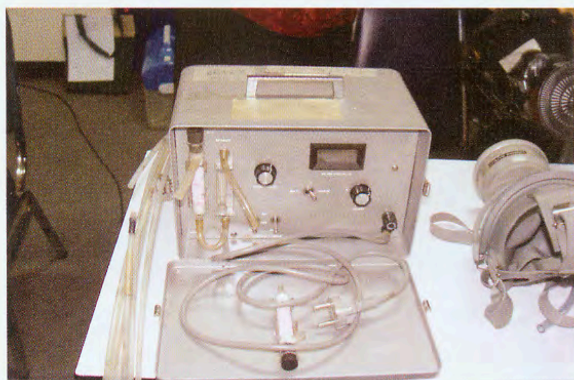
เครื่องวัดแก๊สมethyl bromide (Fumiscope)
