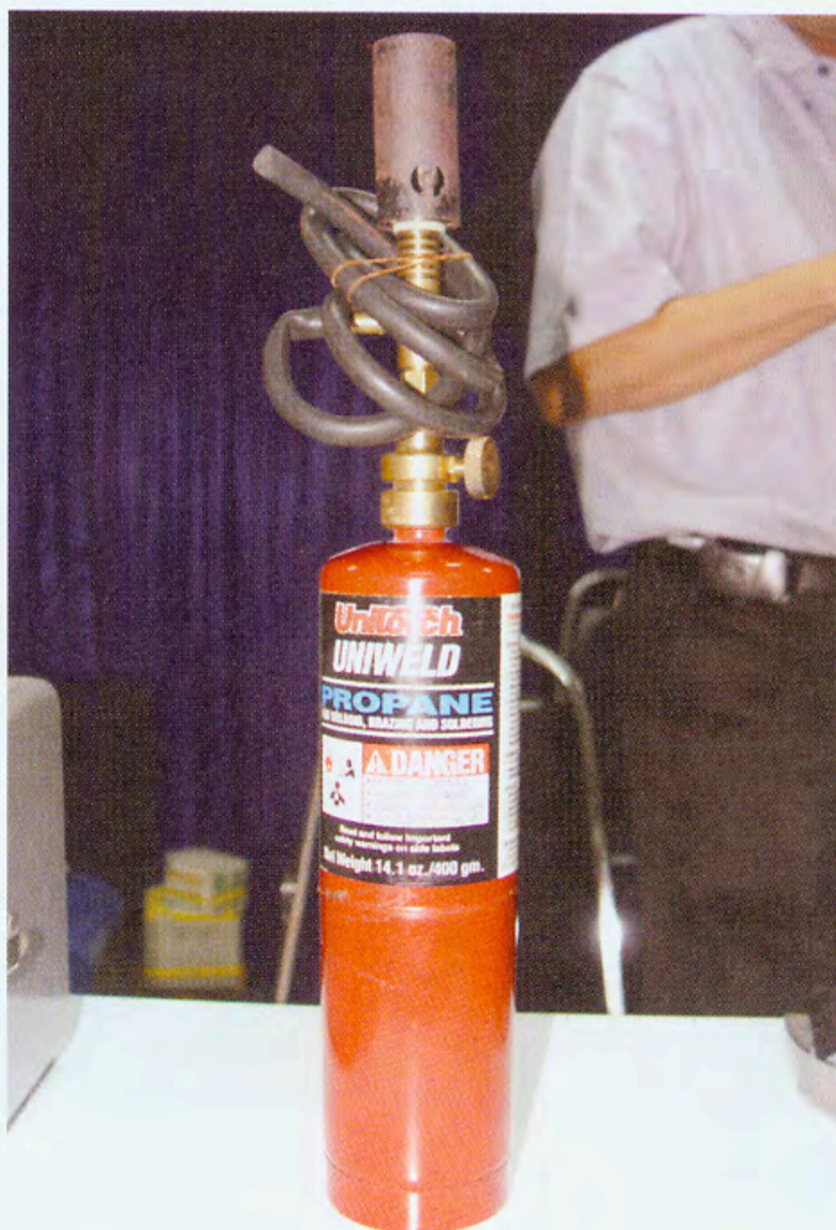
ตะเกียงตรวจสอบการรั่วของแก๊สเมทิลโบรไมด์ (Halide Detector Lamp)
