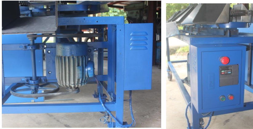
ภาพที่ 4 แสดงตู้มน้ำหนักสถานีชั่งน้ำหนักเครื่องคัดแยกขนาดผลผลิตน้อยหน้า และแสดงสถานีชั่งน้ำหนัก
