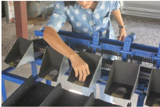
ภาพที่ 6 การปรับตั้งสถานีซึ่งน้ำหนักเครื่องคัดแยกขนาดผลผลิตน้อยหน้าตามน้ำหนักมาตรฐาน
