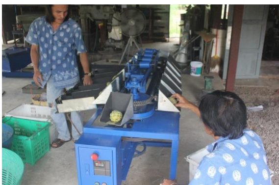
ภาพที่ 8 การทดสอบเครื่องคัดแยกขนาดผลผลิตน้อยหน้าโดยน้ำหนัก(ซ้าย)และผลผลิตน้อยหน้าจากการคัดแยกโดยเครื่องคัดแยกขนาดผลผลิตน้อยหน้าโดยน้ำหนัก(ขวา)
