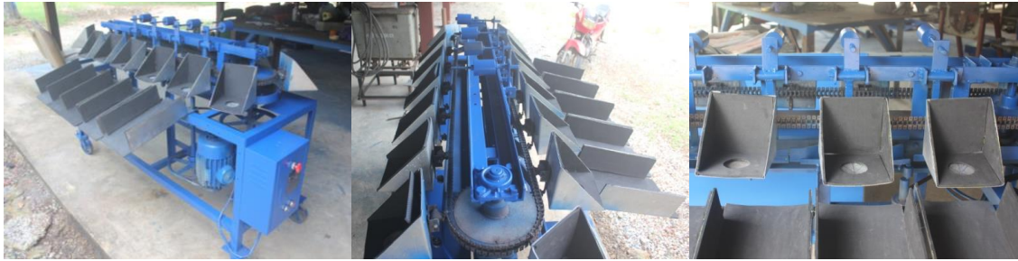
ภาพที่ 3 เครื่องต้นแบบเครื่องคัดแยกขนาดผลผลิตน้อยหน้าโดยใช้น้ำหนัก
