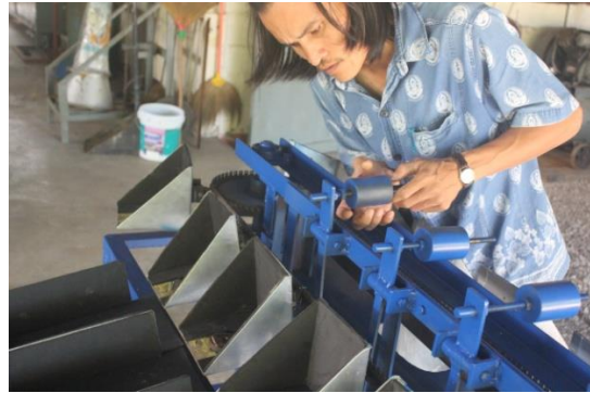
ภาพที่ 6 การปรับตั้งสถานีซึ่งน้ำหนักเครื่องคัดแยกขนาดผลผลิตน้อยหน้าตามน้ำหนักมาตรฐาน
