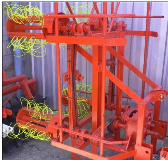
รูปที่ 3 เครื่องสางใบอ้อยที่มีใช้ในปัจจุบัน
