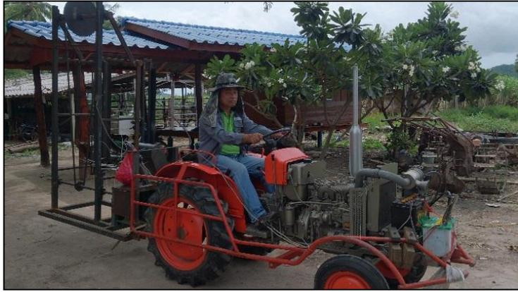
รูปที่ 19 การติดตั้งเครื่องสางใบอ้อยต้นแบบกับรถแทรกเตอร์ขนาดเล็ก 22 แรงม้า
