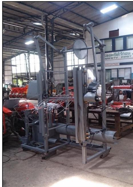
รูปที่ 11 เครื่องสางใบอ้อยต้นแบบ
