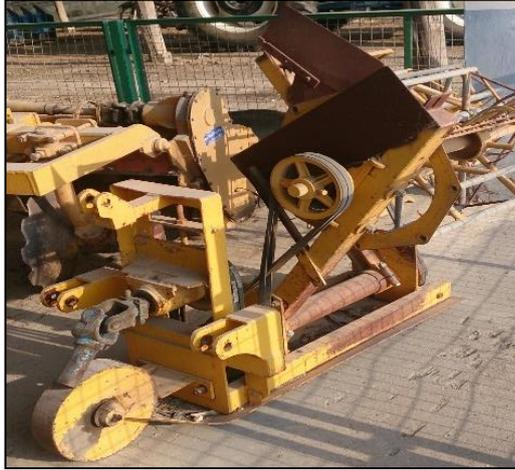
รูปที่ 2 เครื่องสางใบอ้อยติดตั้งกับรถแทรกเตอร์ขนาดเล็ก
