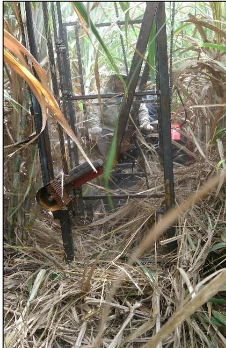
รูปที่ 20 การทดสอบการทำงานของเครื่องสางใบอ้อยต้นแบบในแปลงอ้อย
