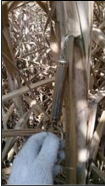
รูปที่ 5 การวัดแรงดึงใบด้วยเครื่องชั่งสปริงขนาด 8 kg.
