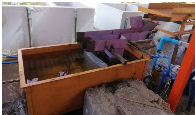
ภาพที่ 8 ต้นแบบเครื่องล้างผลกาแพที่ปรับปรุงใหม่
