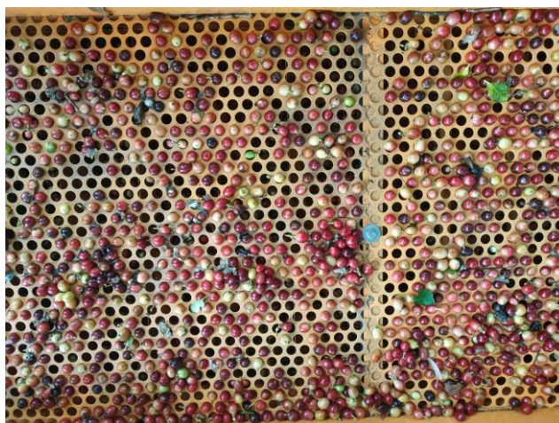
ภาพที่ 1.4 ผลการทดสอบตะแกรงรูกกลมขนาด 10 มิลลิเมตร
