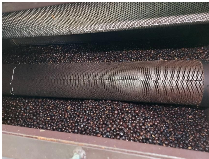
ภาพที่ 3.16 เมล็ดกาแฟบุบตัวลง จนระดับเมล็ดกาแฟต่ำกว่าท่อนมออก
