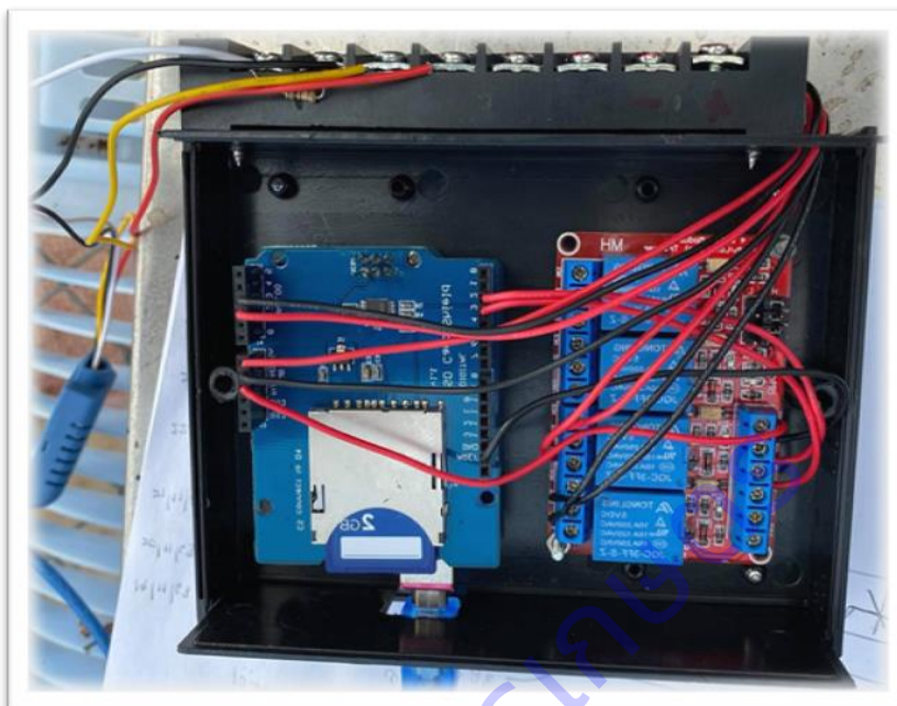
ภาพที่ 2.3 สมองกลฝังตัว ทำหน้าที่ควบคุมอุณหภูมิและความชื้นอัตโนมัติ
