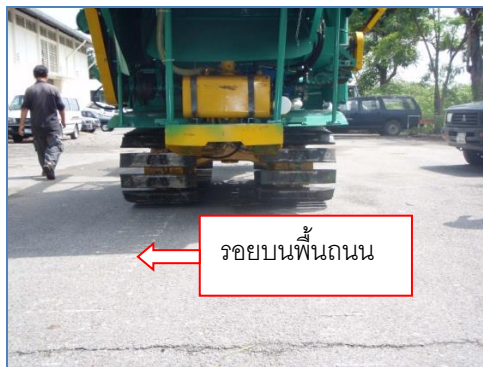
ภาพที่ 9 เปรียบเทียบผิวถนนก่อน และหลังติดตั้งยางดินตะขาบ
