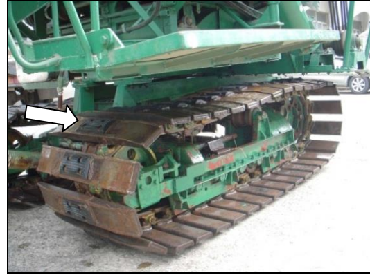
ภาพที่ 16 ยางดินตะขาบที่ติดตั้งแล้ว
