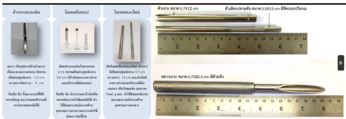
ภาพที่ 3 อุปกรณ์เจาะเก็บตัวอย่างเนื้อมะละกอก แบบเดิม โมเดลตัวเจาะ และโมเดลต้นแบบใหม่อลูมิเนียม พร้อมแท่งอลูมิเนียมต้นสำหรับต้นตัวอย่างมะละกอก (บน) และหลาวเจาะขนาดเส้นผ่านศูนย์กลาง 0.7 เซนติเมตรที่พัฒนาาร่วมกับบริษัทสามร้อยยอด จำกัด (ล่าง)
