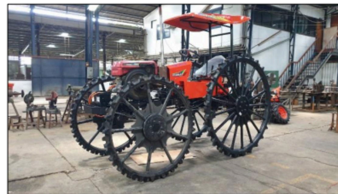
ภาพที่ 1 ต้นแบบรถแทรกเตอร์ยกสูงสำหรับพ่วงอุปกรณ์กำจัดวัชพืชและใส่ปุ๋ยในไร่มันสำปะหลัง
