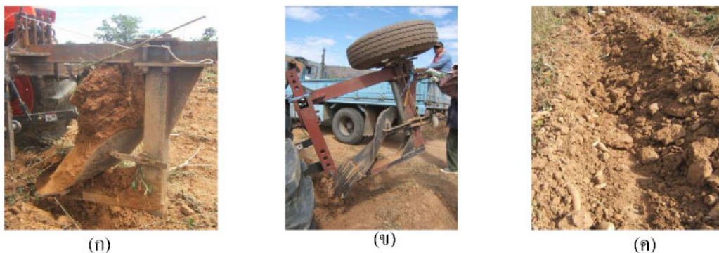
ภาพที่ 5 ชุดในแปลงดินร่วนปนเหนียวมีความชื้นสูง มีดินติดอัดตัวหน้าพาล (ก) พาลชุดแบบซี่พร้อมการถ่วงน้ำหนัก (ข) ผลการชุดด้วยพาลชุดแบบซี่ในดินแห้งและแข็งมีการสูญเสียและเสียหายมาก (ค)
