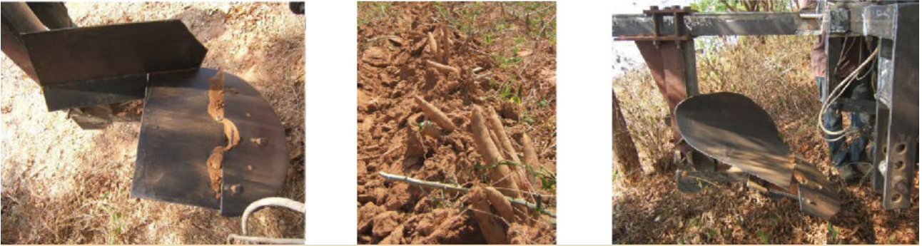
ภาพที่ 6 ผลาขุดแบบปิกไถตั้งตรง (ก) ผลการขุด (ข) และผลาขุดแบบปิกไถโค้ง (ค)
