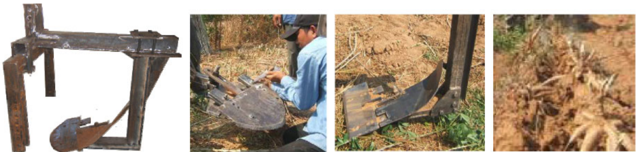
ภาพที่ 3 เครื่องขุดมันสำปะหลังต้นแบบที่สามารถปรับหรือเปลี่ยนชิ้นส่วนเพื่อการศึกษาปัจจัยที่เกี่ยวข้องได้ และผลการขุดจากการทดสอบเบื้องต้น
