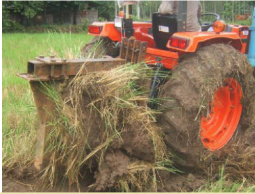
ภาพที่ 8 ดินทรายปนเหนียวความชื้นสูงติดพาลซุด (ก) และผลการไถด้วยเครื่องซุดมันฯ และพาล 7 ในดินร่วนปนเหนียวและอิมตัวด้วยน้ำ
