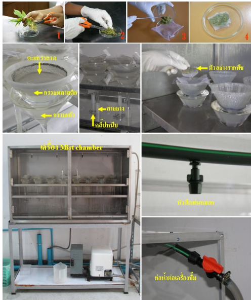
การเตรียมตัวอย่างรากไม้น้ำเพื่อทดสอบการแยกไส้เดือนฝอยด้วย Mist chamber
