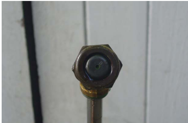
ภาพที่ 1 ข หัวฉีดกรวยกลวงแบบรูฉีดและแผ่นกระแสนแยกกัน (disc and core)
