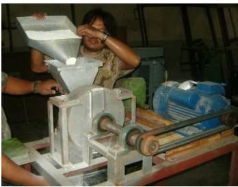
ภาพที่ 3.13 ทดสอบบดแป้งถั่วเขียว ภาพที่ 3.14 แป้งถั่วเขียวที่บดแล้ว ภาพที่ 3.15 นำแป้งไปทำวุ้นเส้น
