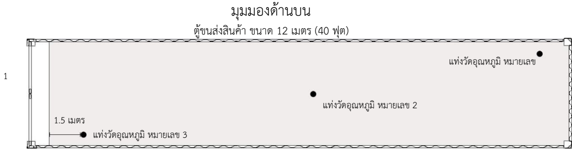
รูปที่ 1 ตำแหน่งการวางแท่งวัดอุณหภูมิผลไม้ภายในตู้ขนส่งสินค้าสำหรับการกำจัดศัตรูพืชด้วยความเย็นระหว่างขนส่ง
