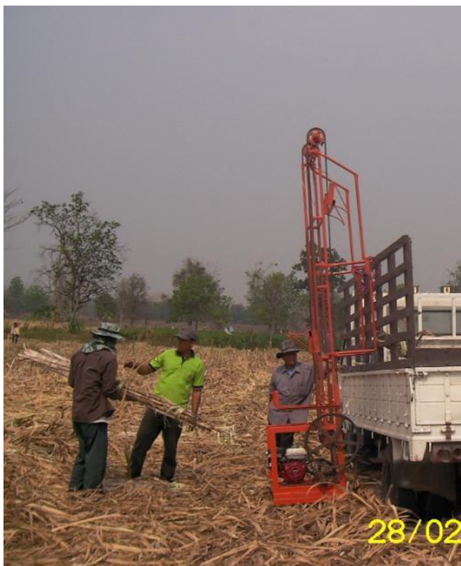
รูปที่ 13 การทดสอบการทำงานเครื่องลำเลียงมัดอ้อย ต้นแบบที่ 2
