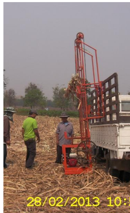
รูปที่ 13 การทดสอบการทำงานเครื่องลำเลียงมัดอ้อย ต้นแบบที่ 2
