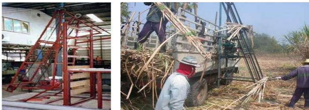
รูปที่ 2 เครื่องลำเลียงมัดอ้อยขึ้นรถบรรทุก และรูปแบบการใช้งาน
