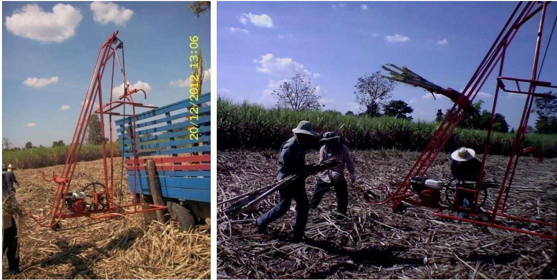
รูปที่ 10 แสดงลักษณะต้นแบบเครื่องลำเลียงมัดอ้อยแบบที่ 1 กับการทดสอบ
