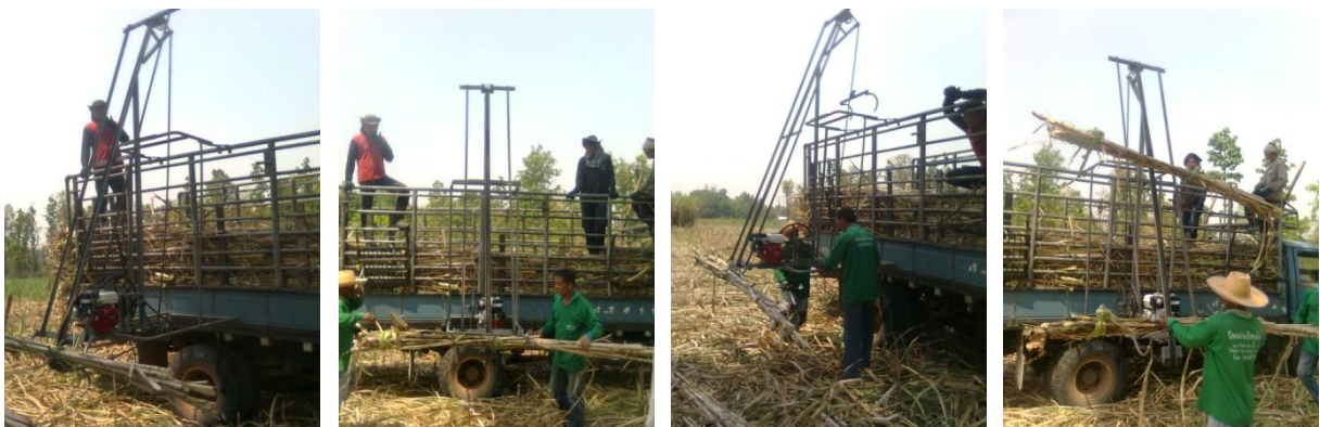
รูปที่ 11 การทดสอบเครื่องขนย้ายอ้อยแบบโซ่ลำเลียงเดี่ยว (ต้นแบบ)
