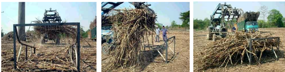
รูปที่ 3 รูปแบบการทำงานของเครื่องแยกทลาย ในแปลงอ้อย
