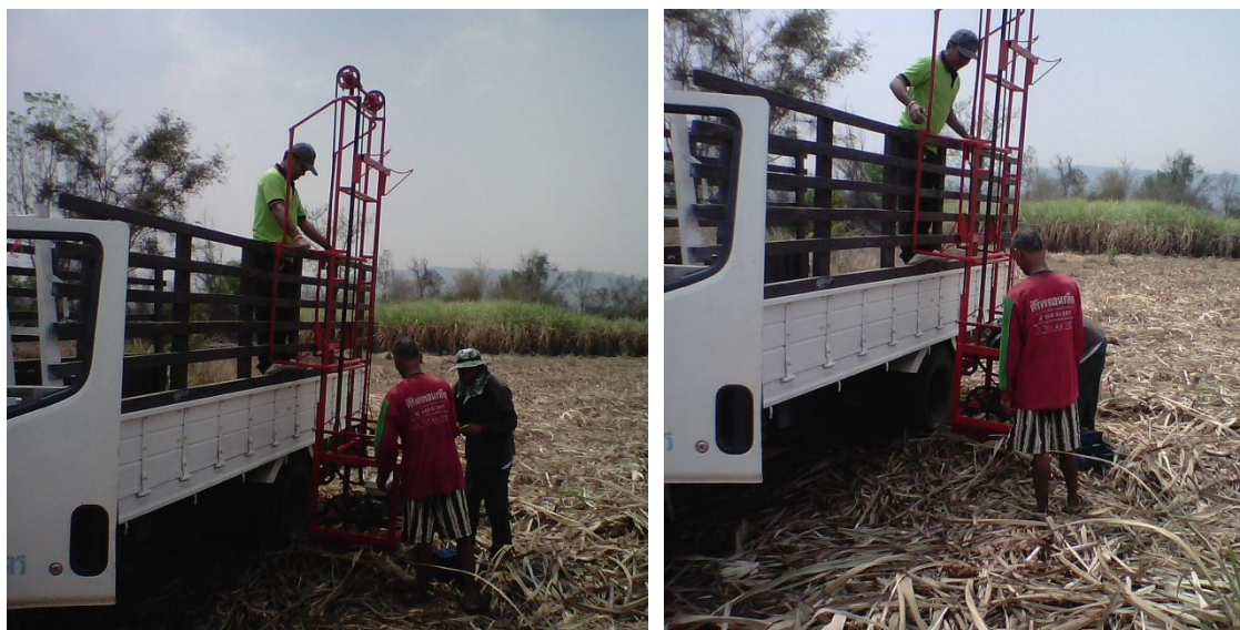
รูปที่ 12 การติดตั้งเครื่องลำเลียงมัดอ้อยขึ้นรถบรรทุก ต้นแบบตัวที่ 2
