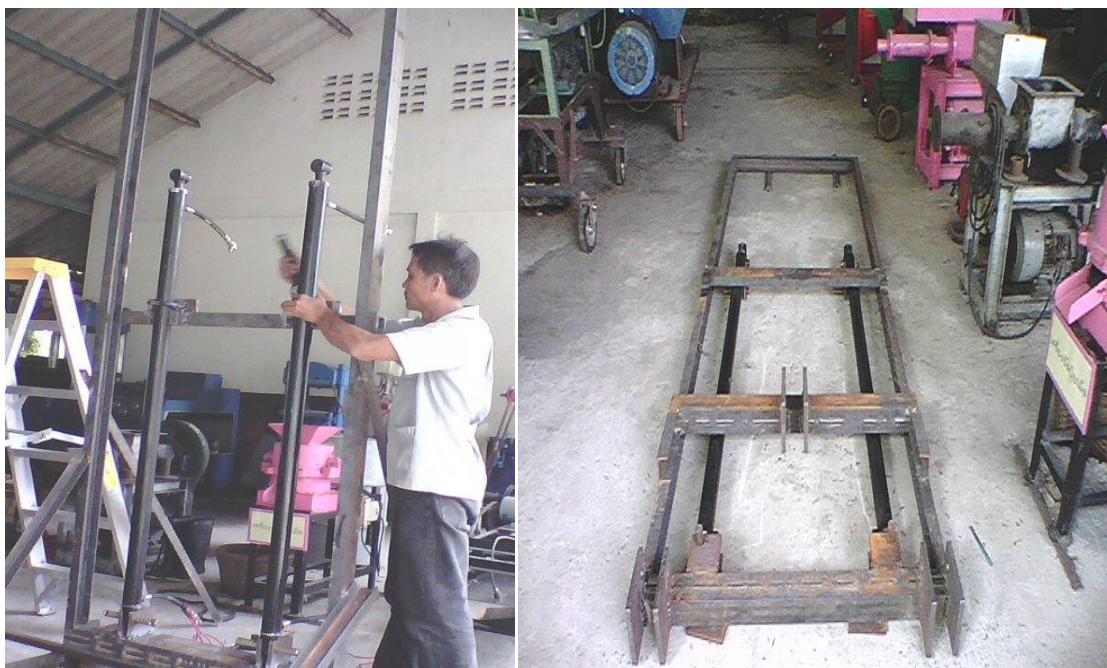
รูปที่ 13 การสร้างและการประกอบกระบะไฮดรอลิกเข้ากับโครงลิฟท์
