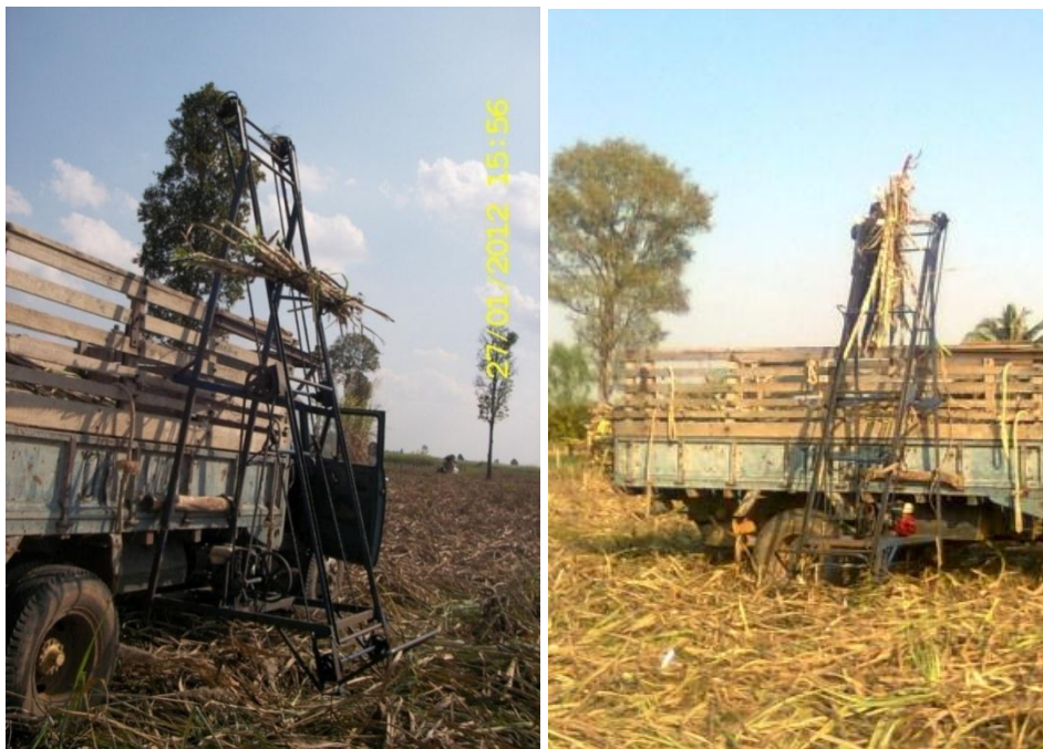
รูปที่ 9 เครื่องลำเลียงมัดอ้อยของเกษตรกรและปัญหาที่เกิดขึ้นกับการใช้งาน
