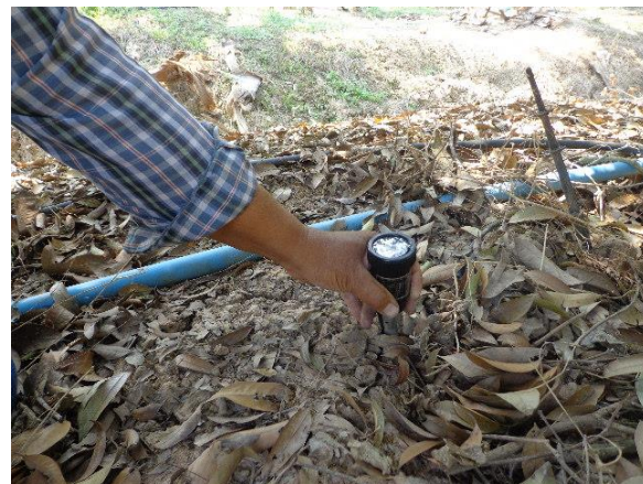
ภาพผนวกที่ 2 การวัดความชื้นในดินก่อนการให้น้ำในแต่ละ กรรมวิธีด้วย soil tester
