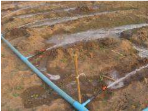
(ก) Gated pipe ขนาดช่องจ่ายน้ำ 3/4 นิ้ว
