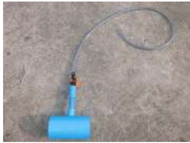
(ก) ข้อต่อแยกออกเป็นวาล์ว ½ นิ้ว พร้อมสายยาง 4 หุน ยาวประมาณ 1.20 เมตร
