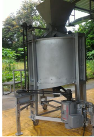
ภาพที่ 2.50 ต้นแบบที่เปลี่ยนมอเตอร์เฟสเดียว แทนมอเตอร์แบบสามเฟส
