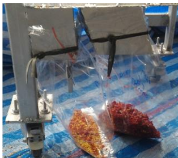
ภาพที่ 2.28 ช่องรับการแยกพริกและเปลือกของเครื่อง
