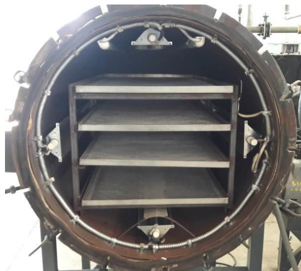
ภาพที่ 4.13 การปรับปรุงระบบสายไฟฟ้าและเซนเซอร์ของห้องอบแบบชั้นวางให้เรียบร้อย
