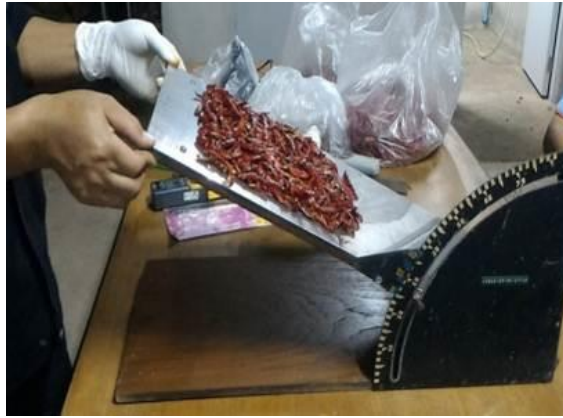
ภาพที่ 2.14 การใช้อุปกรณ์วัดมุมเทหรือมุมการไหลของผลพริกแห้ง
