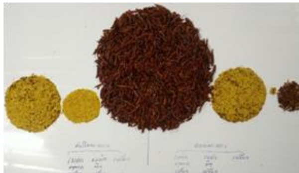
ภาพที่ 2.30 ผลการแยกเมล็ดออกจากเปลือกของพริกจินดาแดง ที่ความเร็ว 21.5 เมตรต่อวินาที
