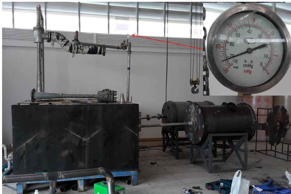
ภาพที่ 4.14 การประกอบปั๊มลดแรงดันอากาศแบบ water jet กับห้องอบแห้งแบบชั้นวาง
