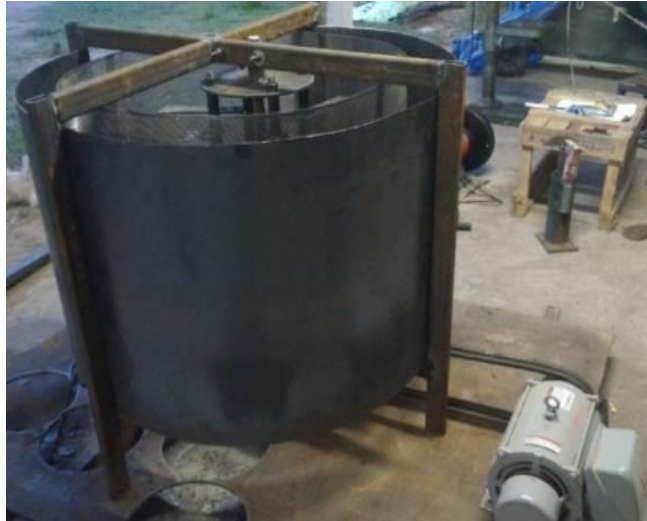
ภาพที่ 2.17 ต้นแบบเบื้องต้นเครื่องแยกเมล็ดพริกเพื่อการทดสอบ
