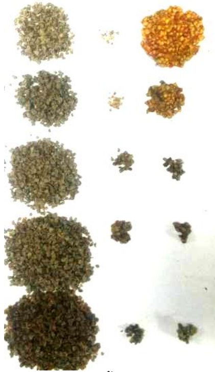
ภาพที่ 2.72 เปรียบเทียบเมล็ดมะเขือเทศหลังการแยกเนื้อออกที่แต่ละความเร็วใบตีแยก ก) เมล็ดที่ผ่านตะแกรงและเข้าสู่ช่องรับเมล็ด ข) เมล็ดที่ตกค้างในตะแกรง ค) เมล็ดที่สูญเสียดูดไปกับเปลือกที่เข้าสู่ช่องรับเปลือก
