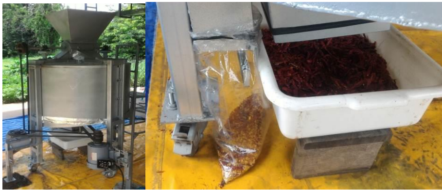
ภาพที่ 2.42 เครื่องต้นแบบที่พร้อมทดสอบ และภาพการตีแยกเมล็ดออกจากเปลือก
