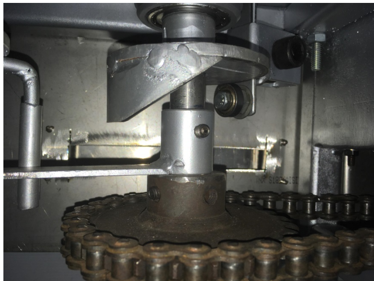
รูปที่ 8 กลไกของชุดลูกเบี้ยว
