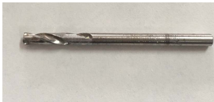
รูปที่ 6 ดอกสว่านขนาดเส้นผ่าศูนย์กลาง 2.5 มิลลิเมตร
