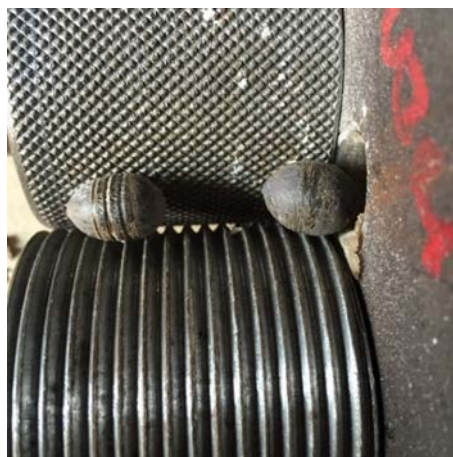
รูปที่ 12 แสดงลักษณะของเปลือกเม็ดบัวที่ถูกกะเทาะโดยลูกกลิ้ง
