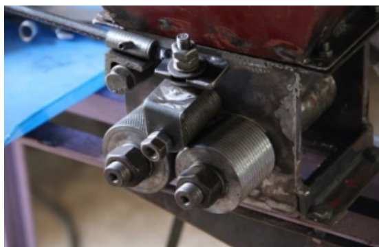
รูปที่ 4 ชุดลูกกลิ้งขึ้นลายสำหรับกะเทาะเปลือกเม็ดบัว
