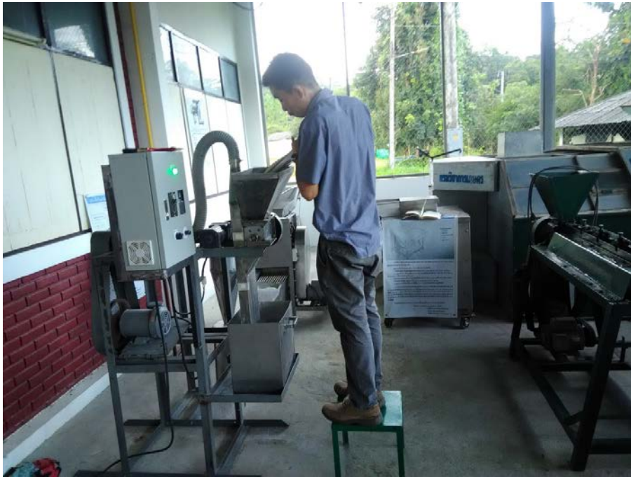
รูปที่ 23 ทดสอบเก็บข้อมูลการใช้งานเครื่องคัดขนาดแป้งโดยใช้ลม ในการคัดขนาดแป้งบัวหลวง
