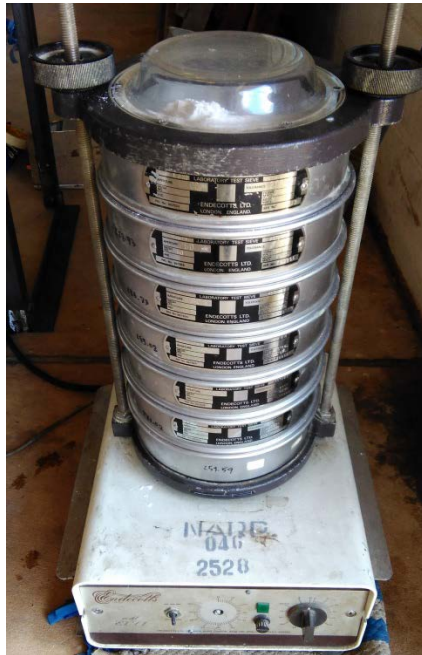
รูปที่ 20 เครื่องคัตขนาดแบบตะแกรงร่อนสำหรับตรวจเช็คเปอร์เซ็นต์แป้งละเอียดและแป้งหยาบ
