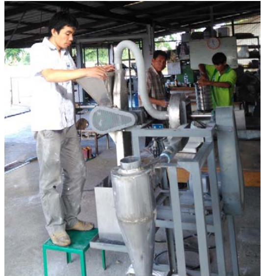
รูปที่ 21 ทดสอบเก็บข้อมูลเครื่องคัดขนาดแป้งโดยใช้ลมในการคัดขนาดแป้งข้าวเหนียว ที่ศูนย์วิจัยพืชไร่ชัยนาท จ.ชัยนาท
