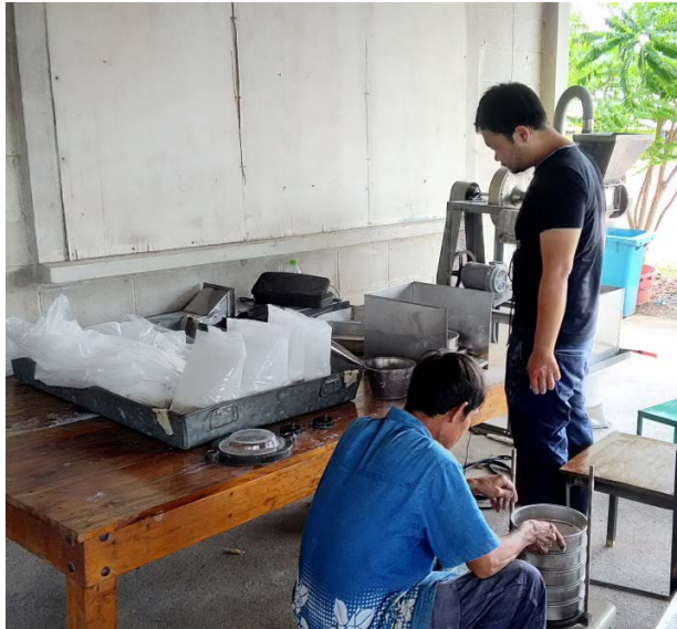
รูปที่ 21 ทดสอบเก็บข้อมูลเครื่องคัดขนาดแป้งโดยใช้ลมในการคัดขนาดแป้งข้าวเหนียว ที่ศูนย์วิจัยพืชไร่ชัยนาท จ.ชัยนาท
