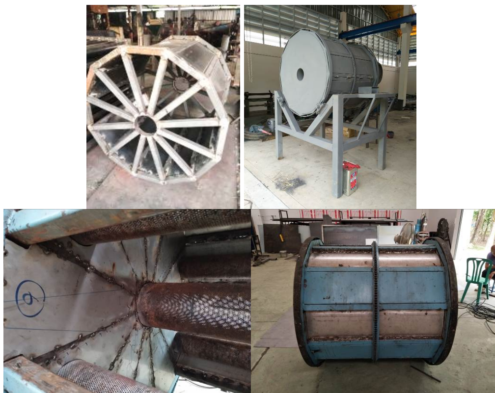
รูปที่ 14 การสร้างเครื่องอบแห้งแบบโรตารี
