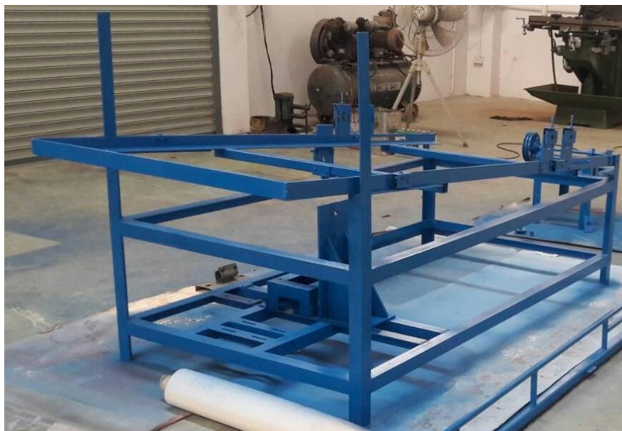
ภาพที่ 22 โครงสร้างเครื่องคัดนามผลสละระดับเชิงพาณิชย์
