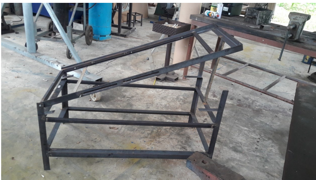
ภาพที่ 7 โครงสร้างของเครื่องตัดหนามผลสละที่สามารถปรับมุมเอียงตะแกรงโยกได้
