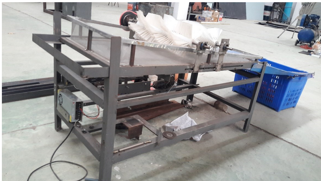
ภาพที่ 14 ต้นแบบเครื่องขั้ดหนามผลสละระดับการทดลอง
