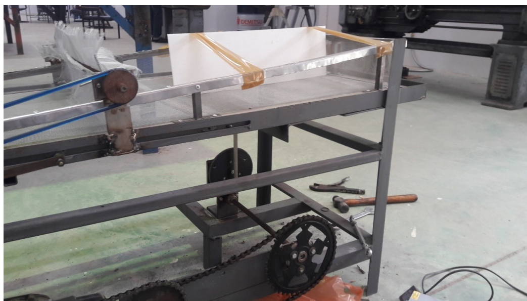
ภาพที่ 13 ต้นกำลังขับเคลื่อนชุดโยกตะแกรง
