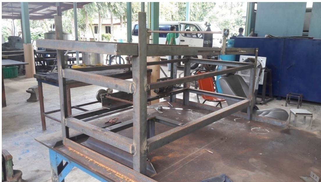
ภาพที่ 8 ติดตั้งแกนเพลลาขับเคลื่อนแปรงขัดหนามผลสละ
