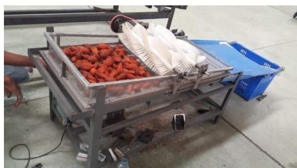
ภาพที่ 17 ทดสอบขีดหนามผลสละด้วยแรงงาน
