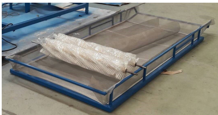
ภาพที่ 23 ชุดตะแกรงโยกและแปรงคัดนาม
