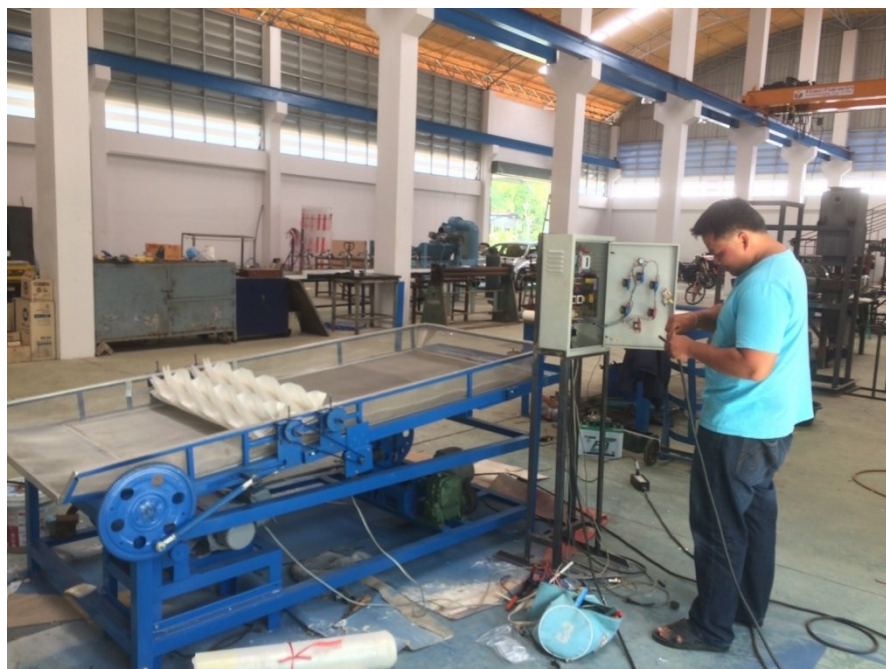
ภาพที่ 28 ติดตั้งตู้ควบคุมการทำงานอัตโนมัติของเครื่องต้นแบบ
