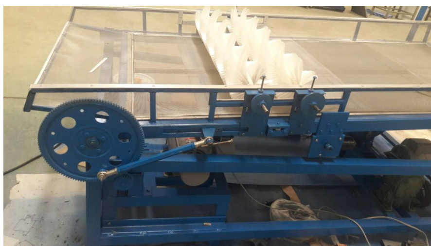
ภาพที่ 24 ชุดอุปกรณ์ขับเคลื่อนตะแกรงโยกและแปรงคัดนาม
