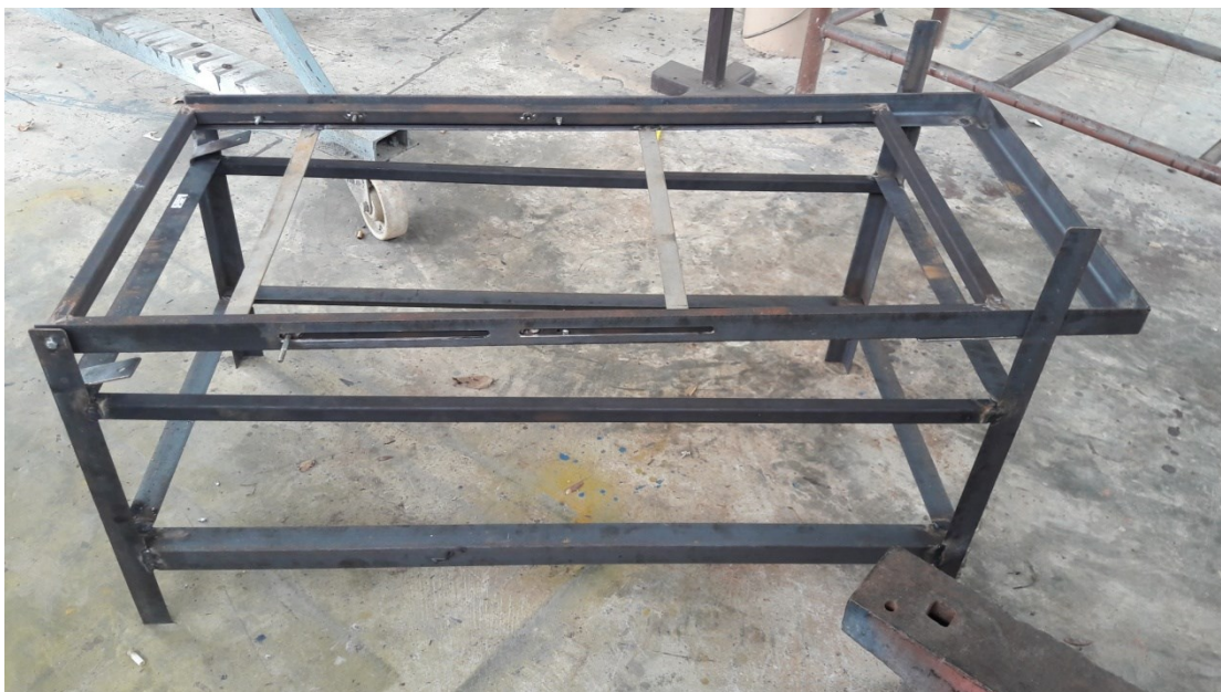
ภาพที่ 6 โครงสร้างของเครื่องตัดหนามผลสละระดับการทดลอง
