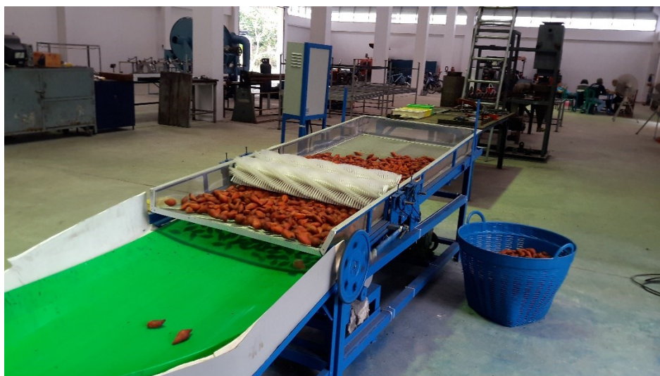
ภาพที่ 31 ทดสอบเครื่องคัดนามผลสละต้นแบบระดับเชิงพาณิชย์
