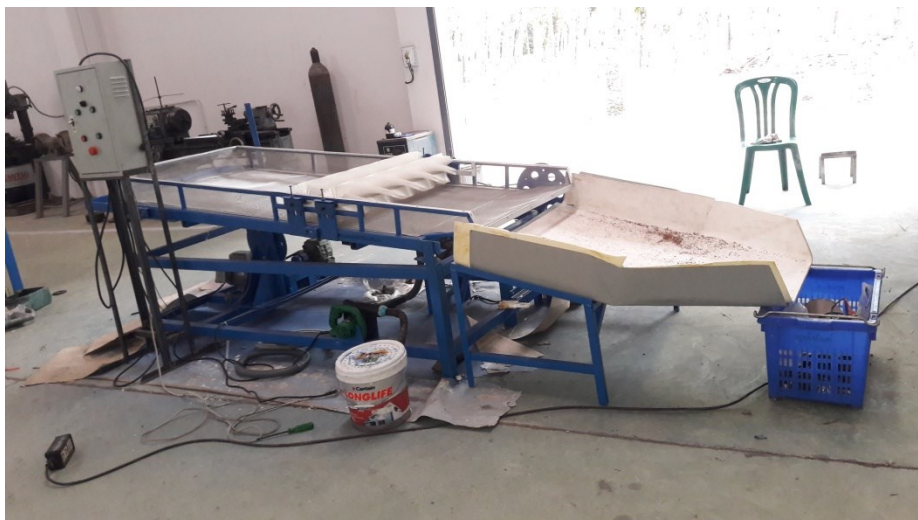
ภาพที่ 30 เครื่องคัดนามผลสละต้นแบบพร้อมทำการทดสอบ
