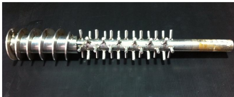
ภาพที่ 7 แสดงแกนชุดขับเคลื่อนปลีอกถั่วเขียวผ่าซีกแช่น้ำ
