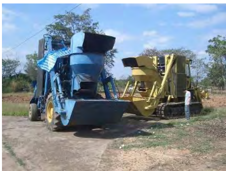
ภาพที่ 1.2 เครื่องเก็บเกี่ยวอ้อยแบบตัดเป็นท่อนที่พัฒนา โดยมหาวิทยาลัยอัสสัมชัญทั้ง 2 คัน
