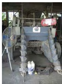
ภาพที่ 1.3 เครื่องเก็บเกี่ยวอ้อยแบบตัดสด เป็นลำที่พัฒนาโดยอรรถสิทธิ์
