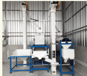
เครื่องคัดแยกแบบตะแกรงและแรงลม
