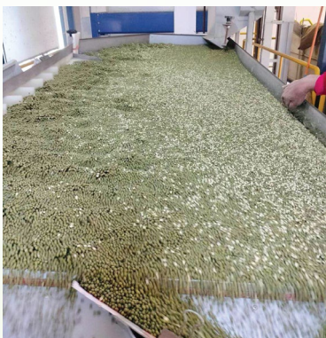
◀ การคัดเมล็ดกล้วยเปียวด้วยเครื่องคัดแยกแบบความถ่วงจำเพาะ (gravity separator)
