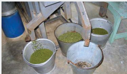
▲ การคัดเมล็ดกล้วยเปียวด้วยเครื่องแบบใช้ตะแกรงและแรงลม (air-screen cleaner)
