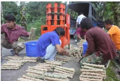
(8-1) การตัดด้วยเครื่องตัดท่อนพันธุ์มันสำปะหลัง
