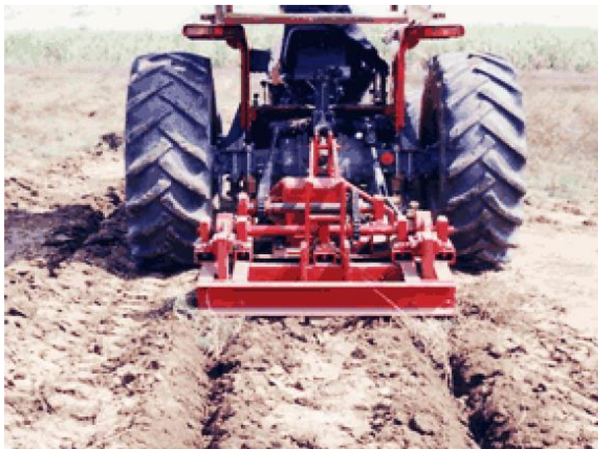
ภาพที่ 19 การไถระเบิดดินดาน ที่มา : (โอภาษ, 2553)
