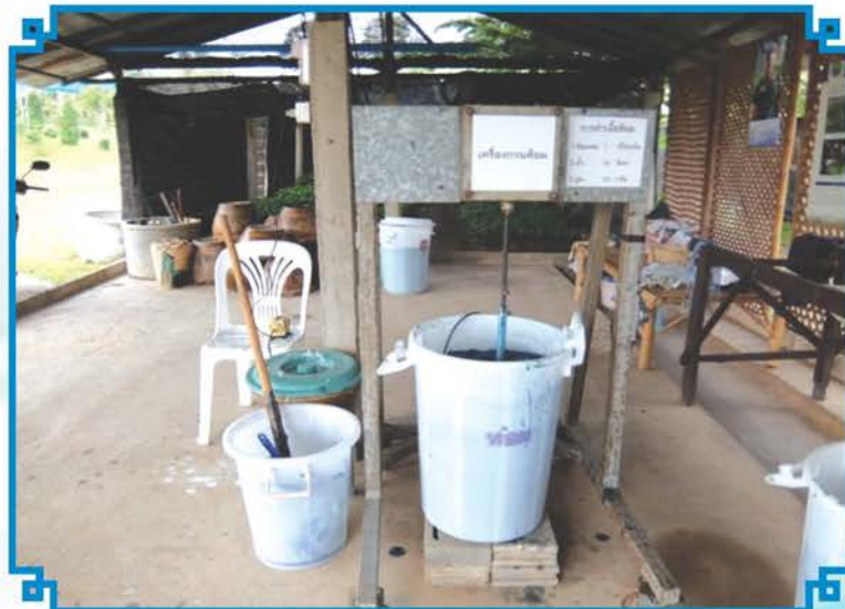
ภาพที่ 19 เครื่องตีน้ำห่อม ทำงานได้เร็วกว่าแรงงานคน 3.7 เท่า
