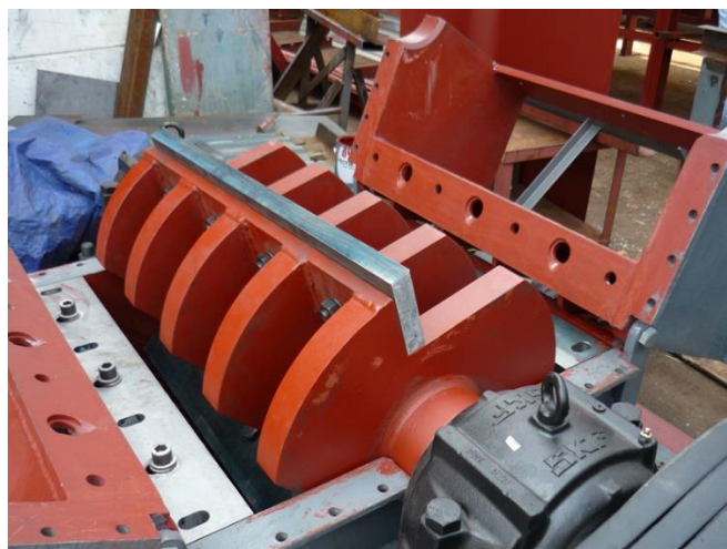
รูปที่ 10 Granulators
