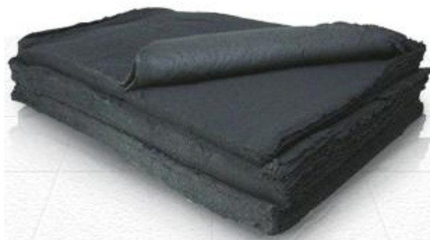
ภาพที่ 31 ยางรีเคลมที่ผสมกับสารเคมีเพื่อเตรียมนำมาวัลคาไนซ์
