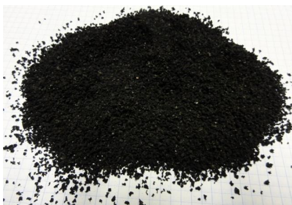
ภาพที่ 30 ยางรีเคลมที่แตกออกเป็นโมเลกุลเล็ก
