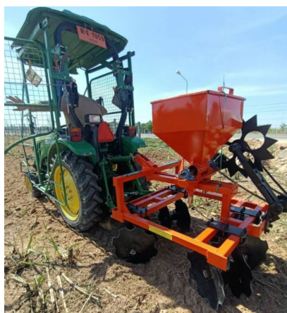
ภาพที่ 4.4.5 ฝาลพรวนพร้อมใส่ปุ๋ย สำหรับอ้อย (แหล่งที่มา : ร้านต่อทองอุปกรณ์ต่อพ่วงแทรกเตอร์)
