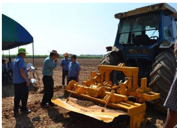
ภาพที่ 4.1.4 ไถพรวนแบบแถบ (Stripe Tillage) กรมวิชาการเกษตร (แหล่งที่มา : อรรถสิทธิ์และคณะ)
