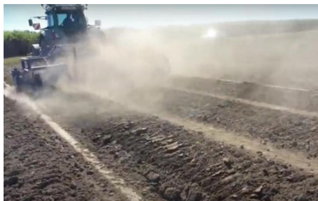
ภาพที่ 4.1.5 เครื่อง Bed Renovator สำหรับเตรียมดิน (แหล่งที่มา : https://www.youtube.com/watch?v=JY9JguWxohw )
