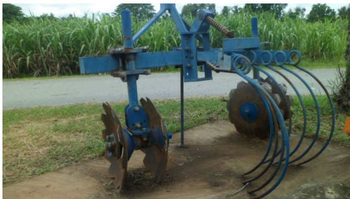
ภาพที่ 3.8.4 เครื่องมือไถพรวนหน้าดินเพื่อกำจัดวัชพืชระหว่างร่องอ้อยโดยใช้คราดสปริง (แหล่งที่มา : ชุศักดิ์ คุณุไทย)
