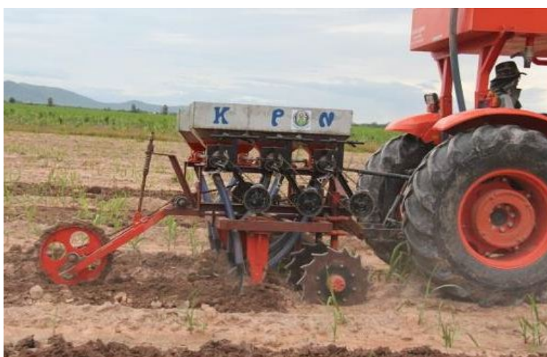
ภาพที่ 4.4.2 เครื่องหยอดปุ๋ยแบบผสมแม่ปุ๋ยภายในตัวเองสำหรับอ้อย
