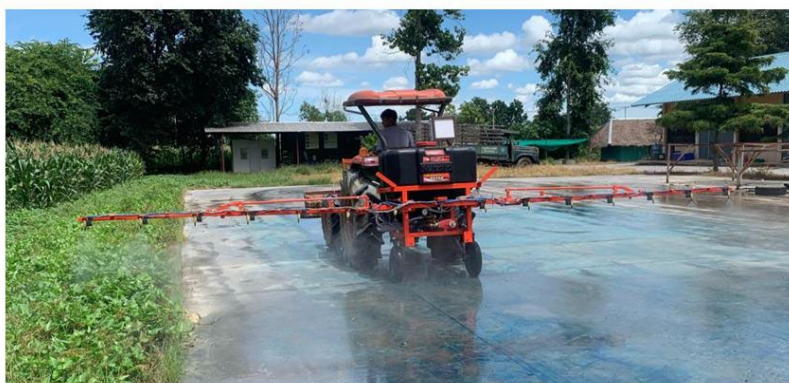
ภาพที่ 4.4.6 เครื่องพ่นสารชนิดแขนพ่นแบบปรับอัตราฉีดพ่นอัตโนมัติสำหรับอ้อย (แหล่งที่มา : ชนิษฐ์และคณะ สถาบันวิจัยเกษตรวิศวกรรม)
