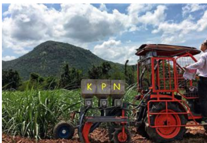
ภาพที่ 4.4.8 เครื่องหยอดแม่ปุ๋ยระบบ GPS สำหรับไร่อ้อย กรมวิชาการเกษตร (แหล่งที่มา : อัครพลและคณะ สถาบันวิจัยเกษตรวิศวกรรม)
